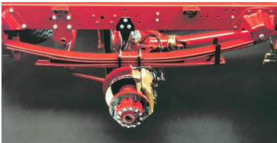
Σχ. 9.27 Μηχανική ανάρτηση.
