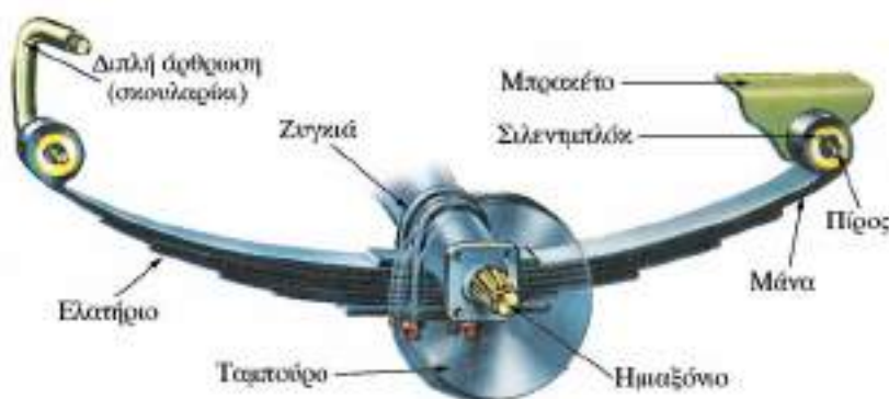
Σχ. 9.28 Χαρακτηριστικά μηχανικής αναρτήσεως.
