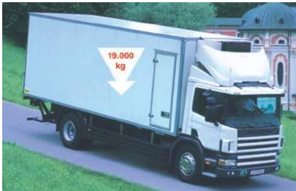
Σχ. 1.15 Μέγιστο επιτρεπόμενο βάρος διαξονικού φορτηγού.
