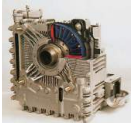
Σχ. 9.36 Υδραυλικός επιβραδυντής.
