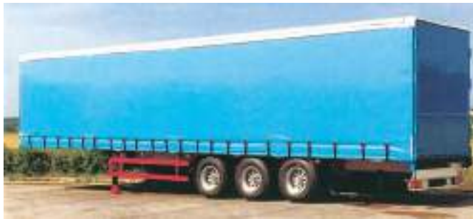
(α) Επικαθήμενο με μεταλλικές αφίδες και σταθερό μουςαμά.
